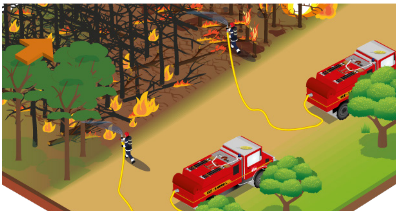
Attaque par établissement de tuyaux au sol.
